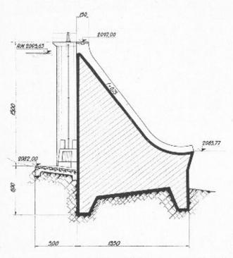
Fig. 5. — Barrage de l'Hospitalet, Coupe sur le déversoir.
