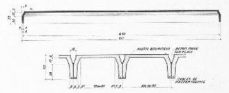
Fig. 2. — Route couverte et gare routière. Poutrelle préfabriquée.
