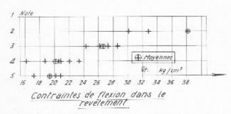
Fig. 3. — Contraintes de compression sur le sol d'assise, de flexion dans le revêtement et déflexions de la surface de la chaussée pour les diverses routes expérimentées en fonction de la note caractérisant le comportement de la chaussée.
