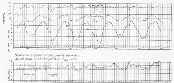
Fig. 4. — Exemple de courbe d'évolution des valeurs fictives des déplacements d'un pendule, calculée d'après les déplacements réels observés, en fonction du niveau du lac et de la température de l'eau.
