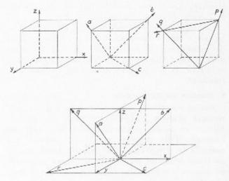
Fig. 3. — Disposition de principe des sondes de mesure des déformations internes du héton.
