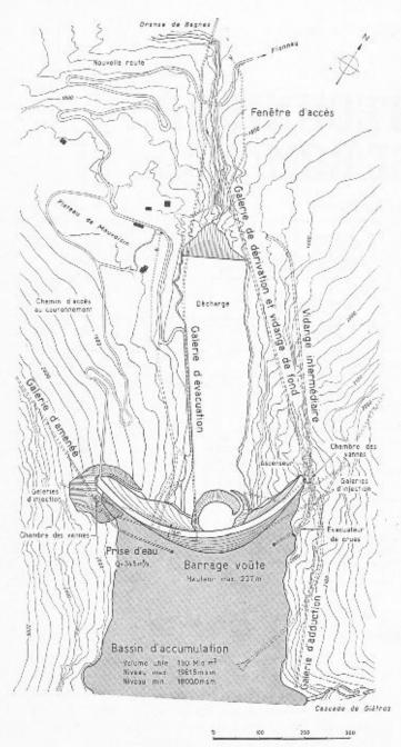
Fig. 2. - Plan de situation du barrage de Mauvoisin.
