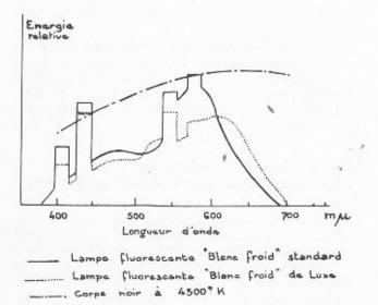
Fig. 3. — Courbes spectrales d'émission (en énergie relative) de deux lampes fluorescentes « blanc froid », l'une « standard », l'autre « de luxe ». Ces lampes ont le même point de couleur que le corps noir à 4500°K dont la courbe spectrale est tracée (en traits-points).
