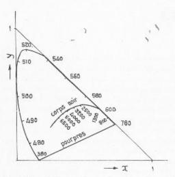
Fig. 2. — Triangle des couleurs suivant le système X, Y, Z de la Commission internationale de l'Eclairage; courbe des points de couleur des lumières monochromatiques (en mμ) et courbe du corps noir (les températures indiquées sont en degrés Kelvin).
