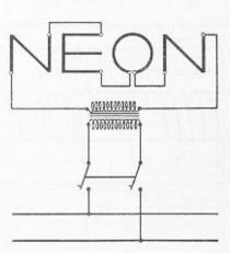
Fig. 8. Diagramme de connexions d'une enseigne lumineuse électrique.
