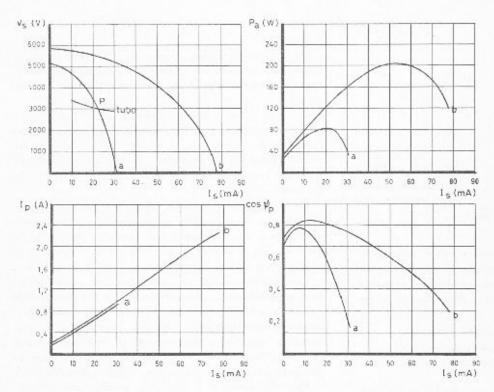
Courbes de fonction-Fig. 6. nement du transformateur Erl CIII, correspondant aux réglages: o shunt maximum o (a) et « shunt minimum » (b).
