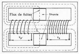
Fig. 5. — Schéma d'un transformateur à grande inductance de fuites.
