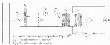
Schéma du montage pour les essais des transformateurs.
