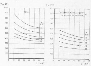
Fig. 3. — Variation de la tension métrique en fonction du courant et du diamètre du tube. Mercure: 300 à 500 mg suivant la longueur du tube.
