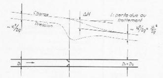
Fig. 18. — Définition de la perte de charge. Cas de la conduite de même diamètre à l'amont et à l'aval.
