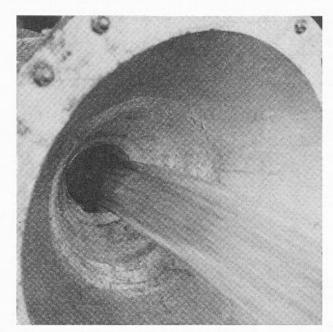
Fig. 22. — Débouché à l'air libre, cône de  $300^{6}$  (b=0.833), débit : 61 l/sec.
