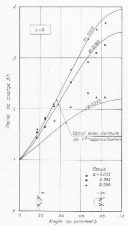
Fig. 25. — Résultats expérimentaux et calcul avec formule (15). Cas où c=0 (débouché à l'air).
