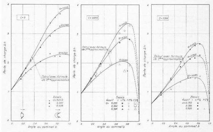
Fig. 32. — Résultats expérimentaux et calcul avec formule (23). Gas où c=0 (débouché à l'air).
