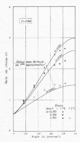
Fig. 27. — Résultats expérimentaux et calcul avec formule (15). Cas où c = 0.264 (conduite aval moyenne).
