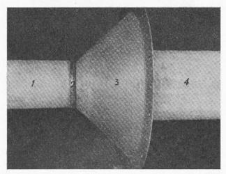
Fig. 15. — Vue du cône de 90° utilisé en position retournée  $(B=270^{\circ}, D_0=154.1 \text{ mm.})$ , avec conduite amont  $D_1 = 200$  mm et conduite aval  $D_2 = 300$  mm, c'est-à-dire = 0.594; b = 0.750; c = 0.264.
