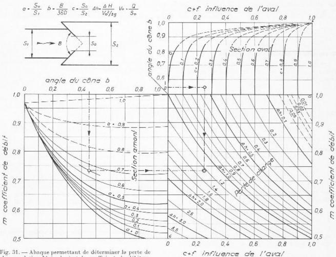
Fig. 31. — Abaque permettant de déterminer la perte de charge relative  $\Delta h$   $(a,\ b,\ c)$  et le coefficient de débit m. Exemple de calcul : a=0.65 b=0.45 c=0.25 on trouve :  $\Delta h=1.23$  (avec f=0 et m=0.735)
