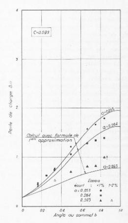
Fig. 28. — Résultats expérimentaux et calcul avec formule (15). Cas où c = 0.593 (conduite aval petite).
