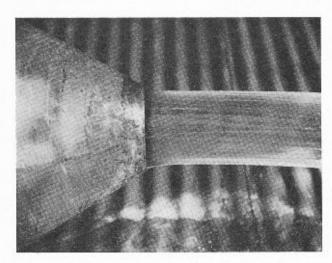
Fig. 21. — Débouché à l'air libre, cône de  $60^{\circ}$  (b=0.167), débit : 93 1/sec.
