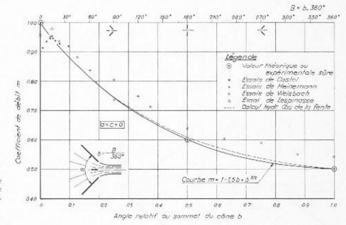
Fig. 6. — Goefficient de débit pour écoulement à travers un orifice circulaire au sommet d'un cône.
