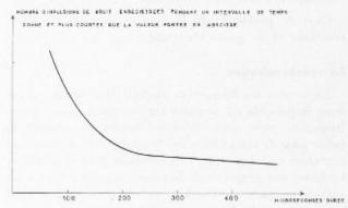
Fig. 3. — Distribution en durée des bruits sur une ligne téléphonique (les impulsions très courtes sont très nombreuses à l'arrivée de la ligne).
