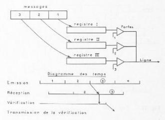
Fig. 19. — Principe de transmission du système duplex total
