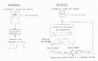
Fig. 7. — Système de synchronisation à démultiplicateurs (rattrapage de phase entre l'information reçue et l'oscillation propre au récepteur).
