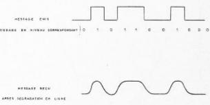
Fig. 5. — Messages échangés sur une ligne téléphonique (distorsion du message reçu par rapport au message émis).
