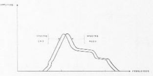
Fig. 2. — Décalage des spectres des fréquences transmises en ligne.
