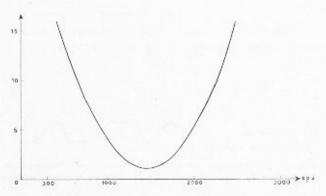
Fig. 1. — Distorsion d'affaiblissement en fonction de la fréquence.
