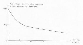
Fig. 9. — Distribution typique des intervalles entre les erreurs. L'échelle verticale étant logarithmique, une loi de Poisson aurait donné une droite partant du point 100 % [résultats d'essais].
