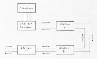
Fig. 20. — Exemple de système utilisant des canaux de transmission communs à plusieurs utilisateurs (plusieurs stations émettrices réceptrices de messages communiquant avec un calculateur central).
