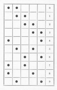
Fig. 42. — Exemple de code fixe : code 2 de 5 (10 combinaisons possibles :  $C_5^2$ ).
