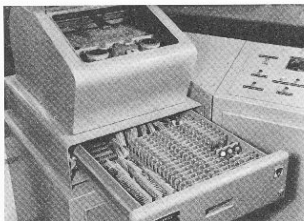
Fig. 15. — Lectrice de carte perforée avec, dans le tiroir inférieur, les circuits de lecture de la carte, le circuit de sécurité et de test et les décodages par diodes.
