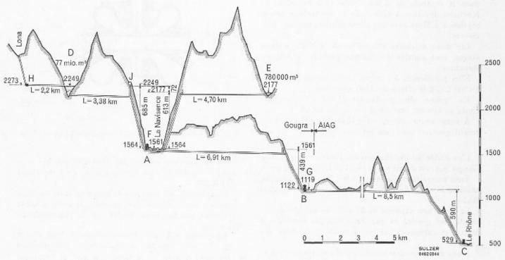
Fig. 6. — Installations de la Gougra S.A. Profil en long lac de Moiry à Chippis,
