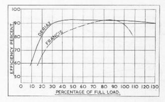
Fig. 22. — Caractéristiques d'une machine Dériaz en turbine
