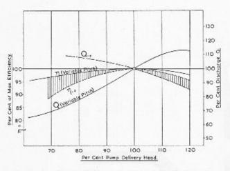
Fig. 21. — Caractéristiques d'une machine Dériaz en pompe.
