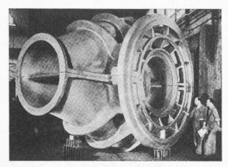
Fig. 19. - Couvercle avec orifice d'aspiration.
