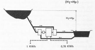
Fig. 10. — Schéma d'une installation d'accumulation journalière, en liaison avec les centrales thermiques.
