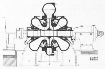
Fig. 4. - Centrale de Stafel. Coupe d'une pompe-turbine.
