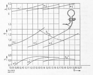
Fig. 26. - Caractéristiques en turbine d'une machine réversible.
