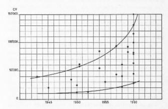
Fig. 11. — Evolution des puissances unitaires des pompes d'accumulation.
