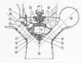
Fig. 20. — Coupe d'une pompe-turbine Dériaz, axiocentrifuge, à aubes mobiles et directrices réglables, d'où très grande souplesse des caractéristiques.
