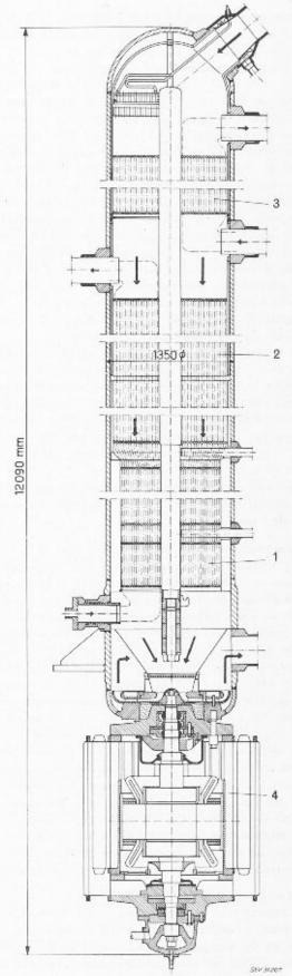
Fig. 13. — Générateur de vapeur et soufflante. 1 Préchauffeur <sup>2</sup> Evaporateur <sup>3</sup> Surchauffeur 4 Soufflante et moteur
