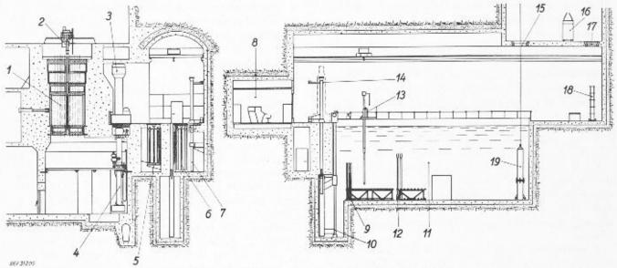
Fig. 11. - Installations de manutention du combustible.
