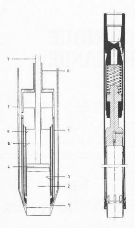
Fig. 1. — Echantillonneur avec gaine de matière plastique (indiquée en pointillé).
