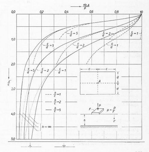
Fig. 8. — Répartition des contraîntes verticales dans la couche élastique sous le centre d'un rectangle chargé uniformément, pour divers rapports des côtés c/d. En abscisse: valeurs  $\sigma \times /p$ ; en ordonnée: valeurs z'/c, z étant la profondeur sous la semelle, c la plus grande demi-dimension du rectangle.
