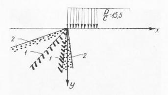
Fig. 2. — Graphique comparatif des zones plastiques dans les cas de solutions élastico-plastiques (1) et élastiques (2).  $c=0.2~\mathrm{kg/cm^3}$   $p=3.1~\mathrm{kg/cm^3}$   $\phi=30^\circ.$
