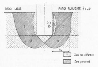
Fig. 5. - Schéma des déformations sous une fondation.
