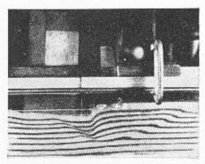
Fig. 3 b. — Surface de rupture au-dessous d'un modèle de largeur B=12,5 cm, chargé obliquement :  $\sigma=1,00$  kg/cm³ ; h=0.
