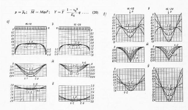
Fig. 11. — Graphiques exprimés en unités sans dimensions des réactions  $\overline{p}$ , des moments  $\overline{M}$  et des déflexions (tassements)  $\overline{Y}$  pour le calcul des poutres d'une rigidité et longueur limitées d'après les différents indices de la flexion de la poutre t et les rapports des côtés  $\alpha$  d'après les formules (2): a) dans le cas d'une charge uniforme q; b) d'une charge P concentrée, appliquée au milieu de la poutre.
