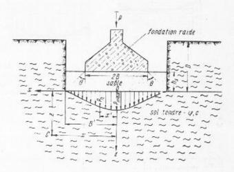
Fig. 14. — Répartition des pressions sur la surface de contact entre le sable et le sol argiléux tendre.
