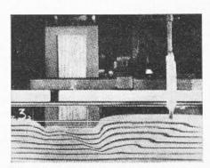
Fig. 3 c. — Surface de rupture au-dessous d'un modèle de largeur B=10,0 cm, chargé obliquement;  $\sigma=1,00$  kg/cm<sup>2</sup>; h=0.
