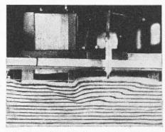
Fig. 3 a. — Surface de rupture au-dessous d'un modèle de largeur B=15.0 cm, chargé obliquement :  $\sigma=1,00$  kg/cm<sup>2</sup> ; h=0.
