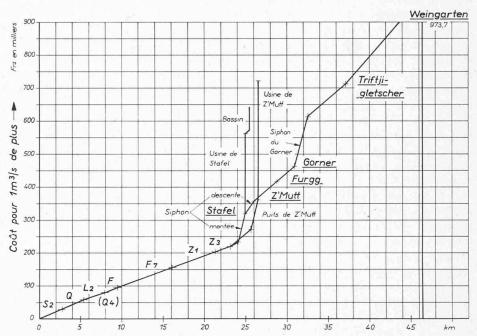
Fig. 3. — Coût d'un agrandissement du collecteur pour un supplément de débit de 1 m³/sec à partir d'un point quelconque en fonction de la distance au lac.
