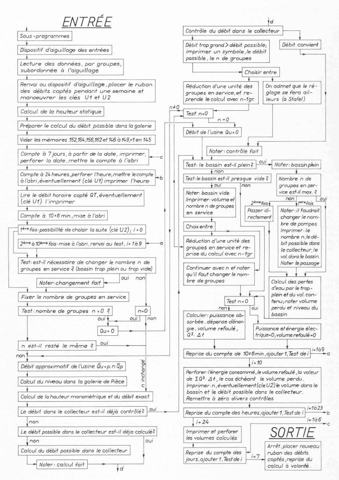
Fig. 5. — Organigramme du calcul de simulation du fonctionnement de l'usine d'Arolla.
