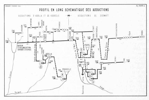
Fig. 2. — Les galeries d'amenée latérales débouchant dans le collecteur sont représentées au-dessus de celui-ci pour la clarté du schéma.
