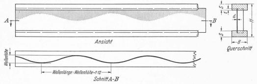
Fig. 1. — La poutre Wellsteg (élévation et coupes).
