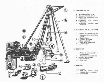
Fig. 1. - Matériel Benoto utilisé au Havre.
