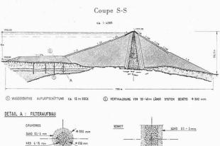
Fig. 16. — Drains de sable digue Göscheneralp.
