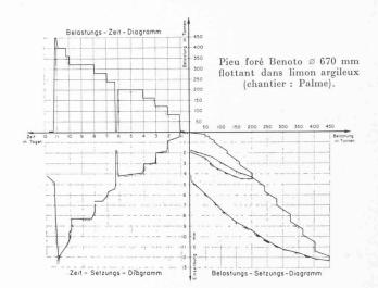
Fig. 8. — Diagrammes de charge et de tassement.
