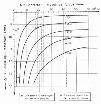
Fig. 11. — Diagramme « Travail de forage ».
