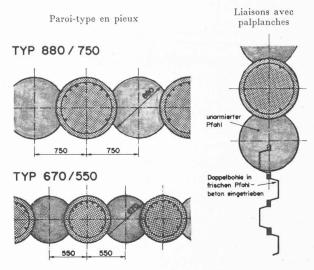
Fig. 12. — Types parois en piles sécantes Benoto.
