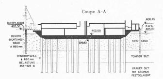
Fig. 14b. - Ecran étanche, chantier « Palme », à Zurich,
