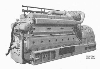
Fig. 2. — Groupe électrogène de 2100 ch (sans silencieux ni caisse d'aspiration). Le groupe est fixé en quatre points au châssis de la locomotive par des éléments élastiques en caoutchouc. A l'extrémité du moteur Diesel, on voit la pompe pour entraînement hydrostatique du ventilateur, le filtre principal pour l'huile de graissage et les deux filtres à combustible.
