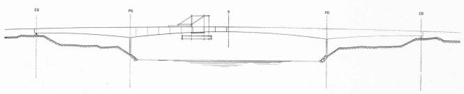
Etape 2 Construction par encorbellement de la partie gauche de la travée médiane en huit étapes de 3,00 m. Diminution successive de la réaction d'appui CG et déchargement du cintre de la travée rive gauche. Commencement du démontage du cintre CG-PG.
