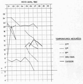
Fig. 8. - Températures à l'extérieur des bétons.
