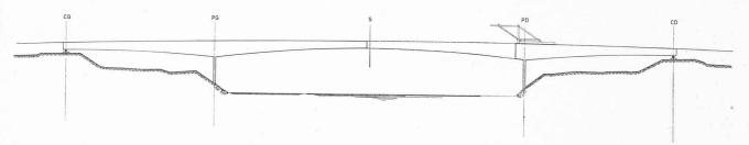
Etape 3 Première partie de la construction par encorbellement terminée, démontage du chariot, bétonnage de la travée rive droite, montage du chariot sur PD, démontage du chariot, montage du cintre CG-PG dans la travée rive droite.
