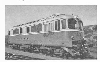
Fig. 1. — Locomotive Diesel-électrique de 2100 ch, série 060-DA, pour les Chemins de fer roumains.
