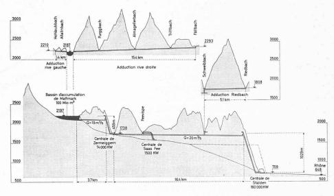
Fig. 12. — Profil en long de l'ensemble de l'aménagement.
