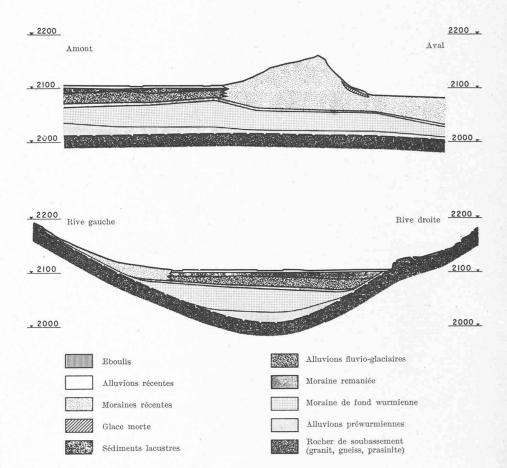
Fig. 7. — Coupes géologiques à l'emplacement de la digue.
