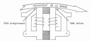
Fig. 3. — Schéma d'une tête de lecture-enregistrement de l'unité de bande magnétique 729.
