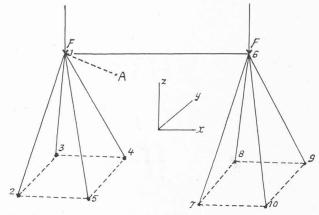
Fig. 2. — Système triplement indéterminé.
