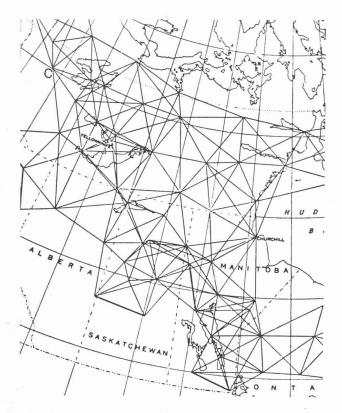
Fig. 1. — Réseau radiotélémétré Hiran.
