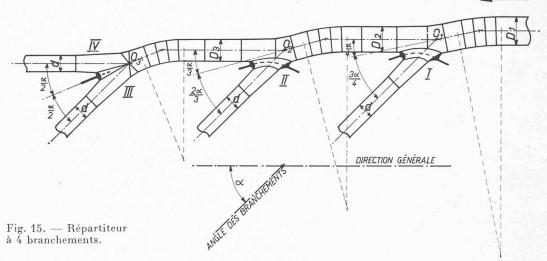
Le débit  $D_2$  est les trois quarts du débit total, alors que le débit des tubulures est un quart. Il est donc logique que la tangente passant par  $O_1$  soit inclinée de l'angle  $\frac{\alpha}{4}$  par rapport à la direction générale. Au point  $O_2$ , l'angle de cette tangente sera  $\frac{\alpha}{3}$  et pour  $O_3$   $\frac{\alpha}{2}$ . Dans la figure 15, le coude nécessaire pour ramener la tubulure IV en parallèle avec les tubulures I, II, III n'est pas représenté.
