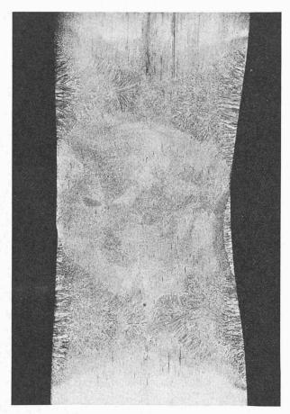
Fig. 9. — Macrographie de soudure double entre un barreau d'acier coulé et tôle. Acier coulé  $109.V.\ R=50-70\ kg\ mm^2$  Tôle acier Feralsim R=52.
