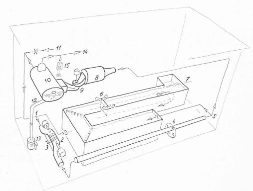
Fig. 17. — Schéma du circuit hydraulique basse chute.
