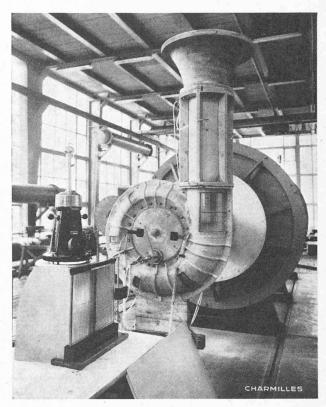
Fig. 11. — Modèle de bâche spirale (essais aérodynamiques).
