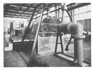
Fig. 13. - Modèle Pelton horizontal à 2 jets.
