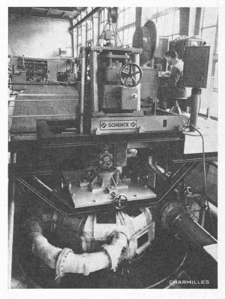
Fig. 12. — Modèle Pelton vertical à 4 jets.
