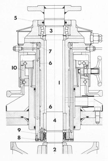
Fig. 16. — Douille oscillante.
