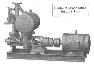
Débits 1-500 I/sec. Aucune soupape de fond. Pas de clapet dans la tubulure d'aspiration. Aucune pompe à vide auxiliaire. Aspiration automatique en tout temps, même après introduction d'air dans le tuyau d'aspiration. Aucune surface d'étanchéité frottante se détériorant à l'usage, d'où fonctionnement exempt de perturbations, aussi dans l'extraction de vase, de sable et de gravier.
