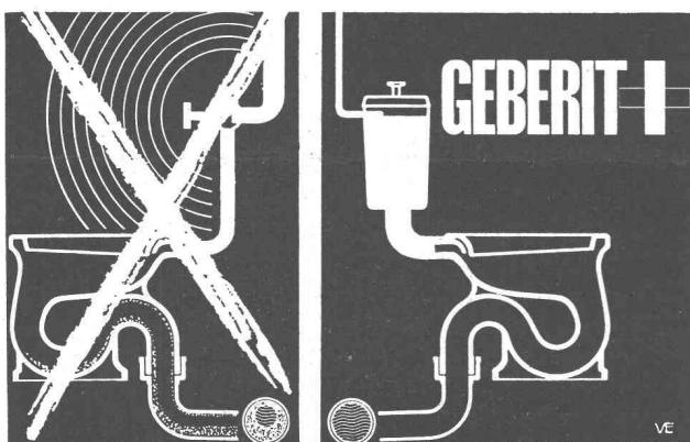
Le réservoir de chasse GEBERIT est silencieux, sûr, élégant et l'ensemble de l'installation ne revient pas plus cher qu'une installation à robinet de chasse.
