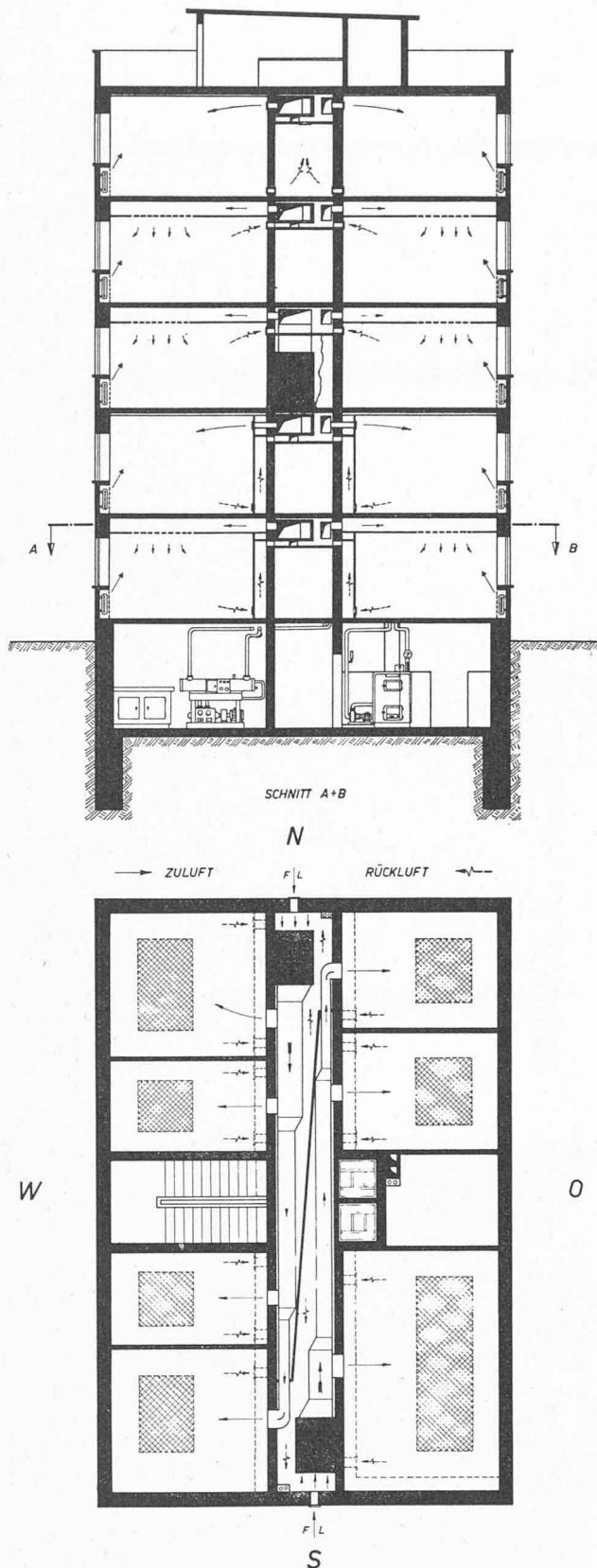
des radiateurs sous les fenêtres. Emploi d'eau chaude pour le chauffage en hiver et d'eau froide pour le refroidissement en été, une chaudière à mazout et un équipement de réfrigération étant installés en cave, dans le local des machines. La régulation de la température se fait par commande pneumatique à action progressive. La température de l'eau est adaptée de façon continue à la charge, en fonction de la température extérieure.
