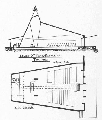
La figure 1 représente en plan et en coupe l'église Sainte-Marie-Madeleine de Troinex, et fait apparaître le schéma de l'installation de chauffage à air chaud.
