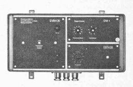
Fig. 10. — Schéma électrique d'un régulateur électronique à asservissement flexible (à gauche) et coffret électronique de commande (à droite).
