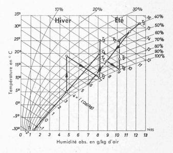
Fig. 22. — Diagramme de l'air humide J-x.
