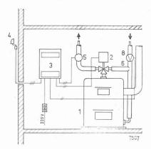
Fig. 27. — Réglage automatique du chaussage central de base.
