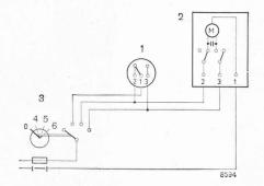
Fig. 4. — Réglage à deux positions d'une vanne motorisée (tout ou rien).
