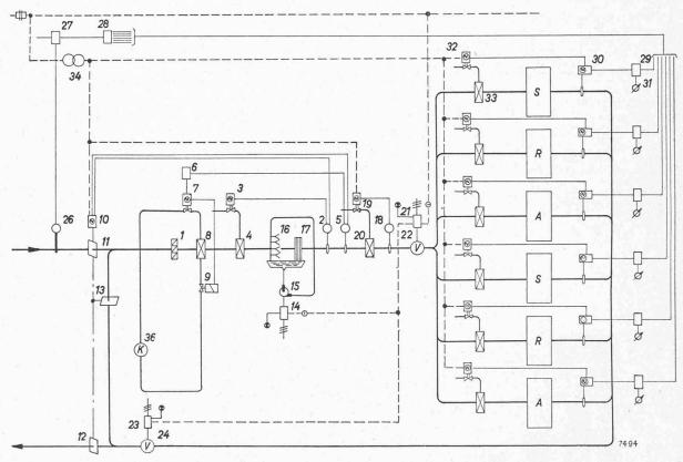
Fig. 19. — Schéma de principe de l'installation de climatisation.
