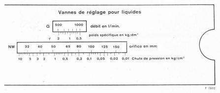
Fig. 15. — Règle à calcul pour vannes de réglage.
