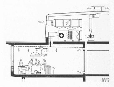
Fig. 6. — Schéma de l'installation de climatisation d'une salle d'opérations.
