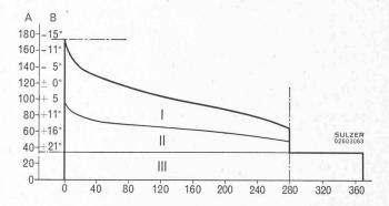
Fig. 2. — Besoin de chaleur (après agrandissement total) en fonction de la fréquence moyenne de la température extérieure journalière.
