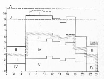
Fig. 1. — Besoin journalier de chaleur prévu pour une température extérieure de  $-15^{\circ}$  C.
