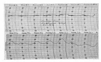
Fig. 19. — Enregistrement de la température intérieure (en haut) et de la température extérieure (en bas) pour la période allant du 28 juillet au 3 août 1958 (le 1er août ayant été, avec une température à midi de 31,6°C, le jour le plus chaud de 1958).
