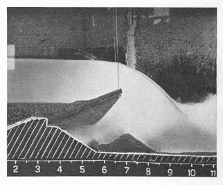
Fig. 22. — Débit total de la rivière : 150 m³/sec. Pression de purge : 10 m.
