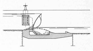
Fig. 13. — Dispositif normal de purge [3].
