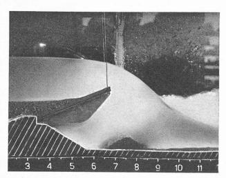
Fig. 25. — Débit total de la rivière : 150 m³/sec. Pression de purge : 15 m.
