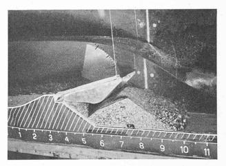
Fig. 6. — Dépôt de matériaux au-dessous du clapet. Débit total de la rivière :  $200~\rm{m}^3/\rm{sec}$ .
