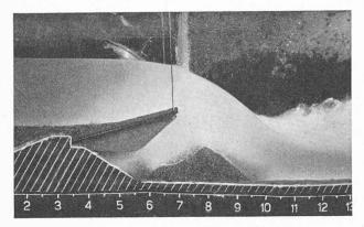
Fig. 28. — Débit total de la rivière : 200 m³/sec. Pression de purge : 20 m.
