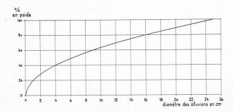
Fig. 3. — Courbe granulométrique des alluvions de la Simme.
