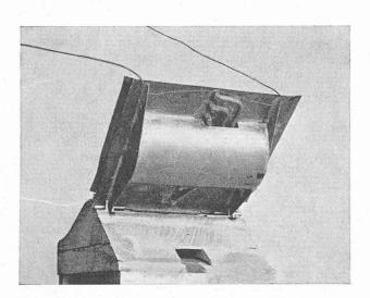
Fig. 14. — Modèle du clapet vu de l'aval, avec un pertuis de purge.
