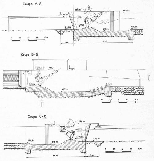
Fig. 38b. — Barrage d'Erlenbach. Projet définitif. — Coupes en travers.
