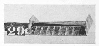
Fig. 20. — Répartiteur de débit placé derrière la fente.
