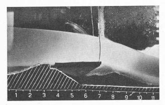
Fig. 29. — Débit total de la rivière : 300 m³/sec. Pression de purge : 20 m.
