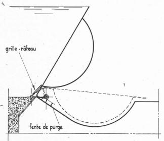
Fig. 37. — Vanne clapet et purge d'après M. Schulz [3].
