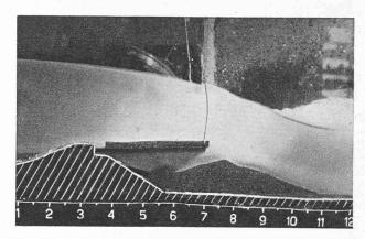
Fig. 27. — Débit total de la rivière : 300 m³/sec. Pression de purge : 15 m.
