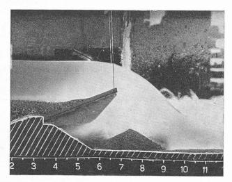
Fig. 24. — Débit total de la rivière : 150 m³/sec. Pression de purge : 30 m.
