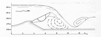
Fig. 5. — Courant de retour au-dessous du clapet.
