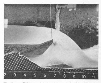
Fig. 21. — Débit total de la rivière : 150 m³/sec. Pression de purge : 4,5 m (correspondant au niveau de retenue).
