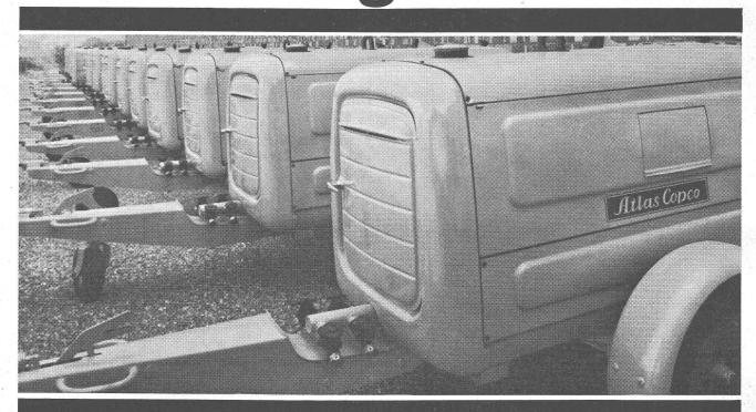
Relation avantageuse poids - rendement - consommation de carburant. Intégralement refroidis par air. Construction simple — entretien aisé. Dispositif de réglage Fuelmiser. Démarrage électrique par batterie de 12 V. Accouplement centrifuge automatique. Compteur d'heures mécanique.
