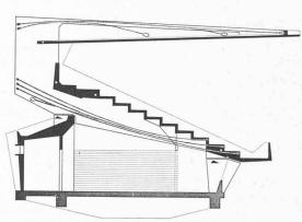
Fig. 5. — Schéma de câblage.
