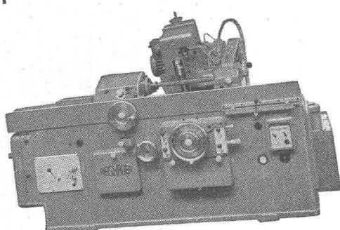
particulièrement indiquée en raison de son rendement extraordinairement élevé et sa possibilité d'utilisation universelle. Pour des pièces de 2 à 250 mm de diamètre, longueur de rectification maximum 450 ou 900 mm. Peut être équipée d'un diviseur automatique et d'un dispositif de dressage semi-automatique.
