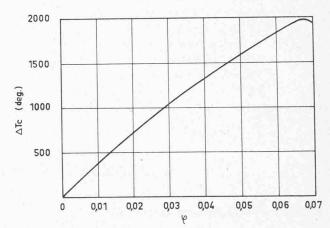
Fig. 2. — Elévation  $\Delta T_C$  de température due à la combustion d'hydrocarbures, en fonction du rapport  $\varphi = débit$  de carburant/débit d'air.
