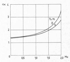
Fig. 3. - Variation du coefficient α = poussée avec rechauffe/poussée sans rechauffe, en fonction du nombre de Mach de vol, et pour deux valeurs (6 et 8) du taux de compression du compresseur.
