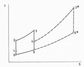
Fig. 1. — Diagramme T-S pour le turboréacteur.
