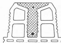
Coupe de la poutrelle préfabriquée : béton périvibré, coiffé par la terre cuite, nervure en T rationnelle ; isolation parfaite.
