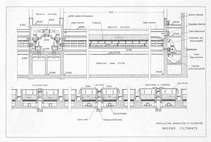
Fig. 19. — Coupes longitudinale et transversale d'un filtre. Phases d'exploitation.
