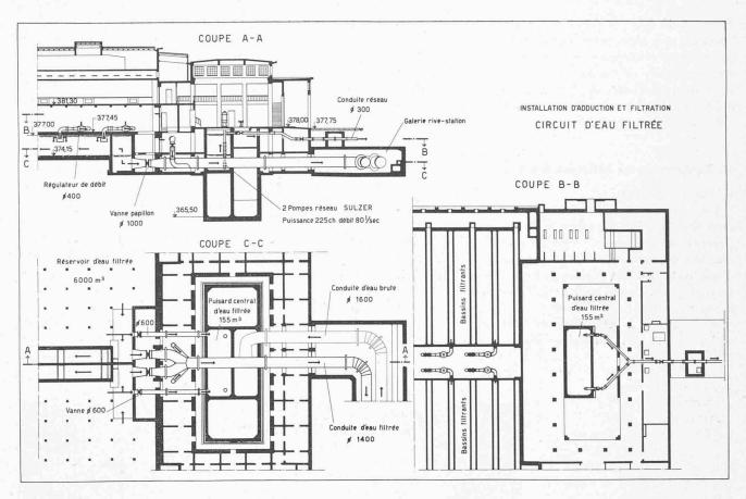
Fig. 18. — Coupes verticale et horizontales des bâtiments montrant le circuit parcouru par l'eau filtrée, de la sortie des régulateurs de débit jusqu'à la conduite de départ Ø 1400 mm.
