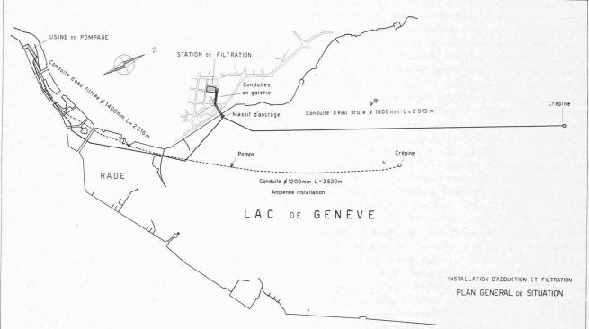
Fig. 2 et 3. — Situation des nouvelles installations d'adduction et de filtration (en traits pleins) avec l'ancienne conduite d'alimentation de l'usine élévatoire de la Coulouvrenière (en traits pointillés).
