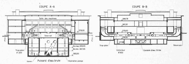
Fig. 9. — Circuit d'eau brute. Installation d'adduction et filtration (voir coupe C - C page suivante).
