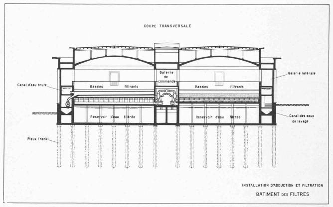
Fig. 6. — Coupe transversale du bâtiment des filtres. Radier sur pieux en béton armé.
