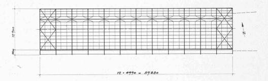
de vue constructif, en fonction de l'ossature et du revêtement. Un contre-cœur de faible hauteur, en briques, est intercalé entre chaque montant et isolé de celui-ci par du carton bitumé.
