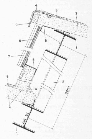
Fig. 9. — Détail du faîte et du chéneau : 1. Membrure de la poutre Vierendeel. 2. Montant. 3 Plaque Durisol. 4. Carrelet de bois. 5. Tôles pliées, formant supports des plaques et des chevrons. 6. Vitrages Thermolux. 7. Chevrons anticorodal. 8. Revêtement AGDAL. 9. Tôle d'étanchéité.
