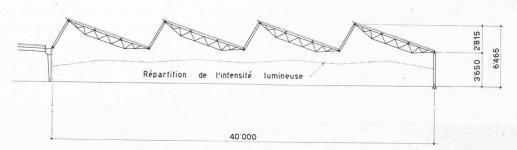
La halle principale, d'une surface de 3500 m<sup>2</sup> environ, est couverte par un toit en sheds ne reposant que sur trois piliers.
