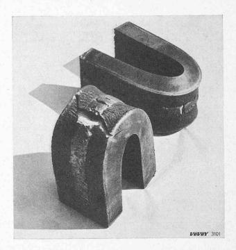
Fig. 3. — Eprouvettes d'essai Kommerell, d'un acier bien ductile.
