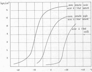
Fig. 1. — Variation de la résilience dans la zone des températures de transition, pour un même acier.
