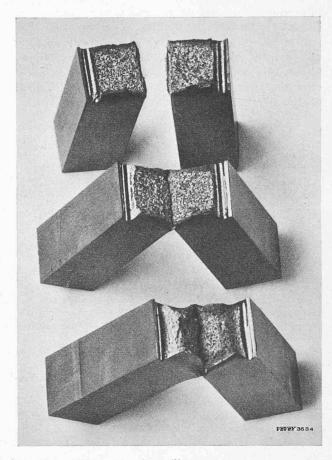
Fig. 2. — Eprouvettes de résilience rompues. En haut, cassure sèche et brillante, sans striction, d'un acier fragile. Au milieu, cassure médiocre. En bas, cassure mate, avec forte striction, d'un acier bien ductile.
