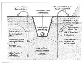
Abaissement de la nappe d'eaux souterraines, Procédé Vacuum, système du Professeur Streck, ingénieur au moyen de filtres en matière synthétique et de pompes
