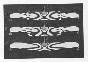
Fig. 4 A, B, C. — Photographie des isochromes des lames méridiennes principales des trois plaques étudiées (épaisseurs des lames:  $e_A=3,28\,$  mm,  $e_B=3,17\,$  mm,  $e_C=3,40\,$  mm,  $P=7,27\,$  kg).
