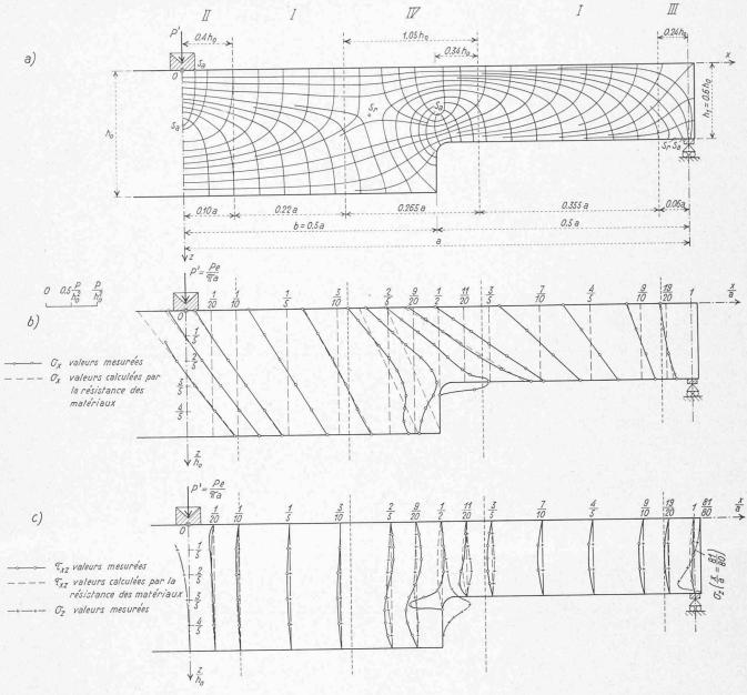
Fig. 8 a, b, c. — Modèle de la poutre figure 1 B. a) Trajectoires des tensions principales b), c) Diagrammes des tensions  $\sigma_x$ ,  $\sigma_z$  et  $\tau_{xz}$ .
