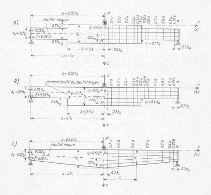
Fig. 1 A, B, C. — Coupe axiale des trois modèles de plaques étudiées (respectivement, vue des modèles des poutres correspondantes) précisant également les points situés aux intersections de deux systèmes de droites  $\gamma$ , où les tensions ont été déterminées ( $a=4\ h_0$ ).
