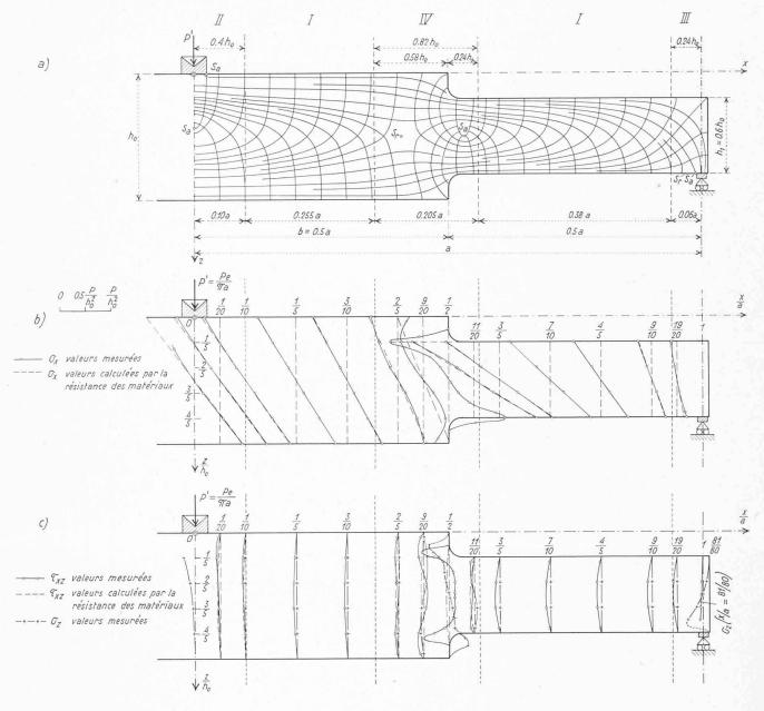
Fig. 6 a, b, c. — Modèle de la poutre figure 1 A. a) Trajectoires des tensions principales b), c) Diagrammes des tensions  $\sigma_x$ ,  $\sigma_z$ , et  $\tau_{xz}$ .
