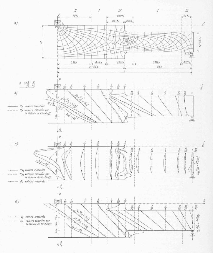
Fig. 5 a, b, c, d. — Modèle de la plaque figure 1 A. a) Trajectoires des tensions principales b, c, d) Diagramme des tensions  $\sigma_r$ ,  $\sigma_z$ ,  $\tau_{rz}$  et  $\sigma_t$ .
