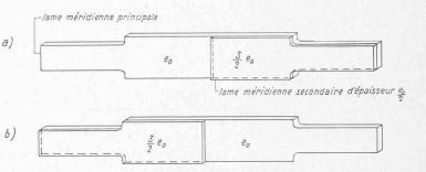
Fig. 2 a, b. — Lame méridienne secondaire de la plaque représentée fig. 1 A, placée successivement dans deux positions sur une lame méridienne principale, pour permettre de photographier les isoclines en éliminant les isochromes.
