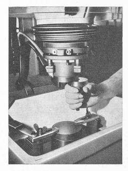
Fig. 4. — Porte-électrode à rotule et à fixation magnétique qui permet l'enlèvement et le remplacement rapide et précis de l'électrode, l'adaptation du tasseau de réglage et du microscope de centrage.
