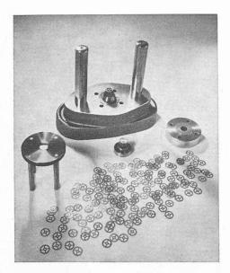
Fig. 5. — Matrice de décapage usinée par l'Eleroda D 1. Il s'agit d'une matrice en carbure de tungstène.
