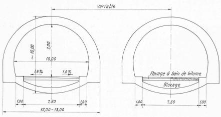
Fig. 1. — Profils transversaux types.
