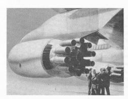
Fig. 1. — Solution Boeing pour le 707.
